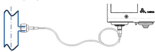
若您购买的是带毛细管的型号, 请直接将毛细管的喇叭口与系统管路连接
