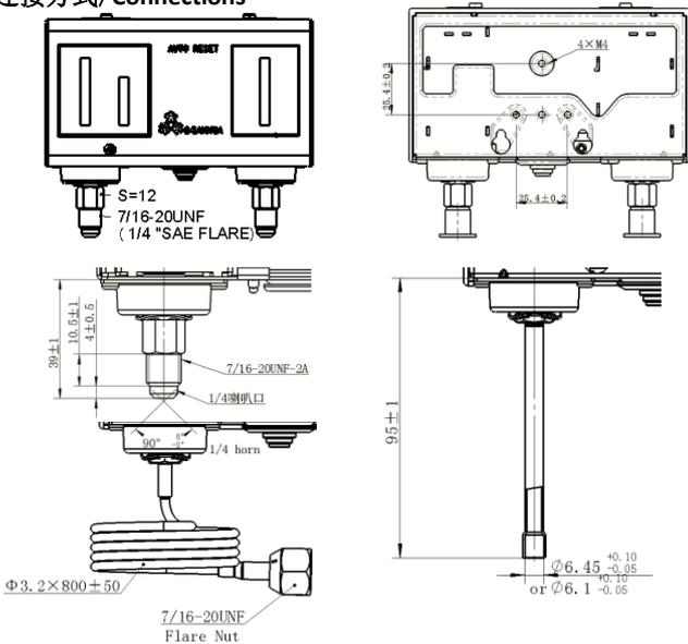
接头连接方式可根据客户要求提供, 接头配备防尘帽, 防止异物进入感压部件, 导致进气口堵塞, 影响产品动作性能。
